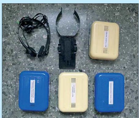
Bild 2: Kopfhörer, Morse-Paddle mit Kniehalterung und beschrifteten Zubehördosen
