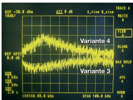
Bild 3: Rauschen der Varianten 3 und 4 am Ausgang; RBW = 3 kHz
