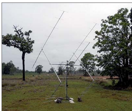
Die vier Zehnelement-Yagi-Antennen von E2E; notdürftig geflickt und gleichwohl erfolgreich Foto: DL2LAH
