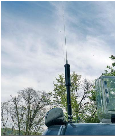
Bild 4: Diamond SD-330 komplett, auf dem Autodach montiert
