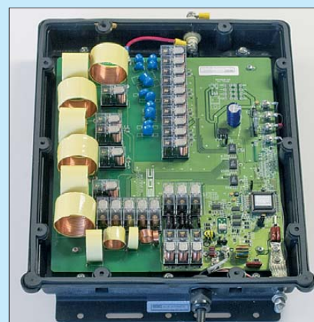
Bild 33: Innenleben des für Außenmontage geeigneten unsymmetrischen Automatikkopplers „Smartuner“ SG-237 von SGC
