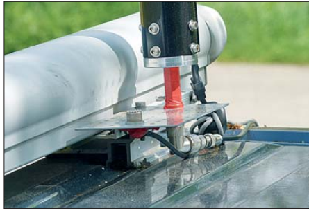
Bild 3: Provisorische Befestigung der Tarheel-300 auf dem Dach des Wohnmobils
