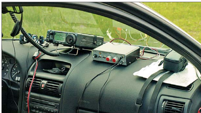
Bild 8: Die Portabelstation von DJ3TZ für UKW-DX wird aus einem Bleigel-Akkumulator gespeist.
