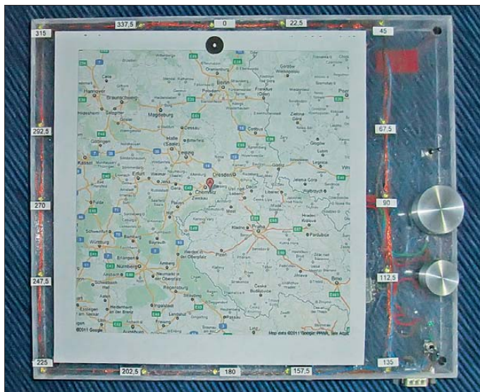
Bild 1: Frontplatte des Steuergeräts für den Antennenrotor mit der von 16 LEDs umrahmten Beam-Karte und den Bedienelementen auf der rechten Seite
