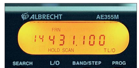
Bild 2: Das kleine kontrastreiche LC-Display zeigt die wesentlichen Parameter; ein S-Meter fehlt.
