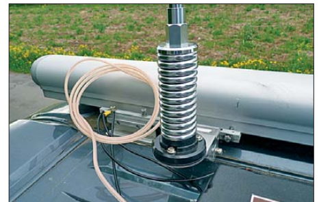
Bild 12: Fuß der Diamond TK-1173A mit Automatikkoppler Fotos: HB9ERD
