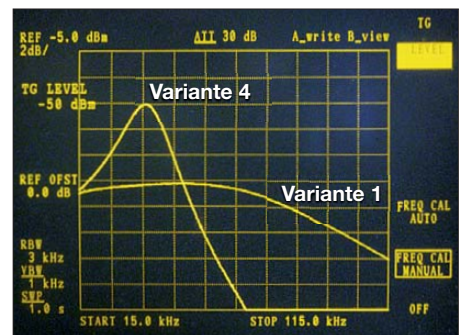
Bild 8: Signalpegelverlauf von 15 kHz bis 115 kHz im Vergleich der Varianten 1 und 4
