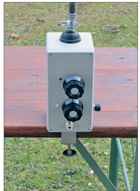
Bild 3: Abstimmkasten stehend, mit Schraubzwinge am Tisch befestigt
