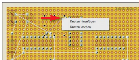
Bild 5: Das Verlegen eines Drahtes ist über zusätzliche Knoten auch gewinkelt möglich.
