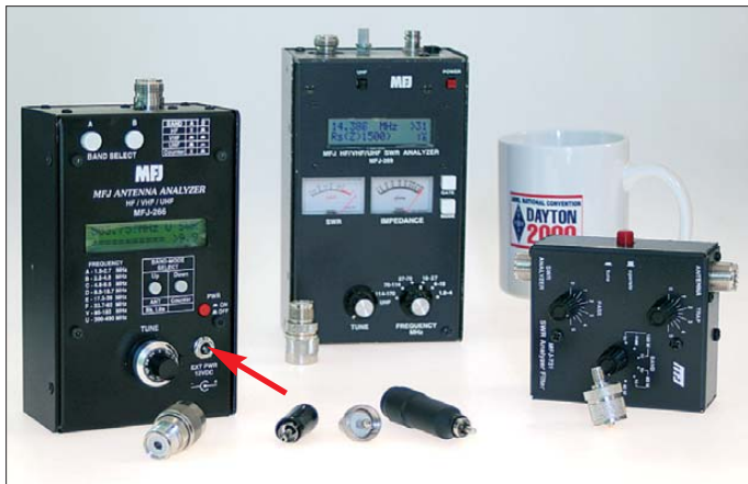
Bild 1: Im Vordergrund v. l. n. r. der MFJ-266, der Spulensatz MFJ-66 und das unter gestörten Umgebungsbedingungen erforderliche Vorsatzfilter MFJ-731; im Hintergrund der von der Hamvention 2000 mitgebrachte (und heute noch erhältliche) MFJ-269
