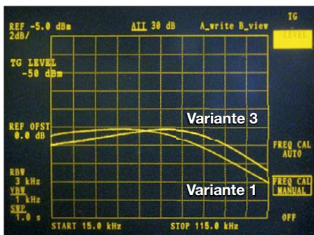
Bild 7: Signalpegelverlauf von 15 kHz bis 115 kHz im Vergleich der Varianten 1 und 3
