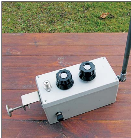
Bild 1: Abstimmkasten liegend; links im Bild ist die Schraubzwingenbefestigung zu erkennen.
