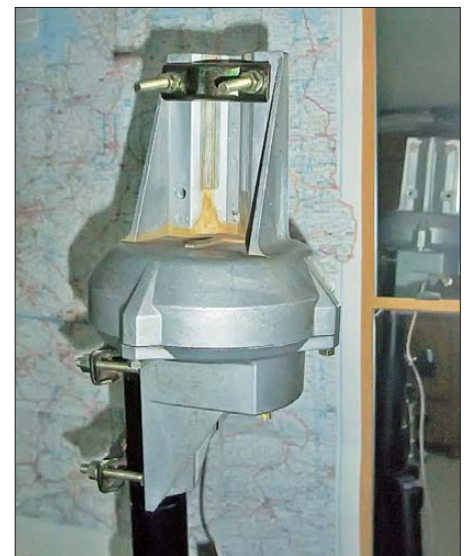
Bild 2: Verwendeter Rotor; für den Umbau eignen sich auch andere Exemplare, da sich in der Regel die erforderlichen Änderungen problemlos vornehmen lassen und die zusätzlichen Bauelemente im Gehäuse Platz finden.
