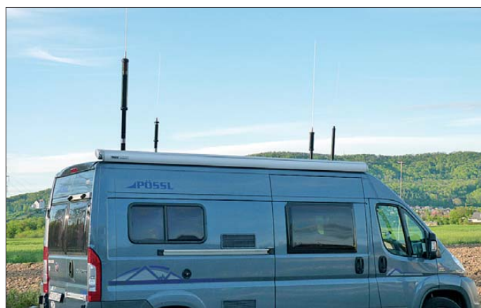
Bild 1: Tarheel-300, Little Tarheel, Diamond SD-330 und ATAS-120 (v. l. n. r.) auf dem Wohnmobil des Autors
