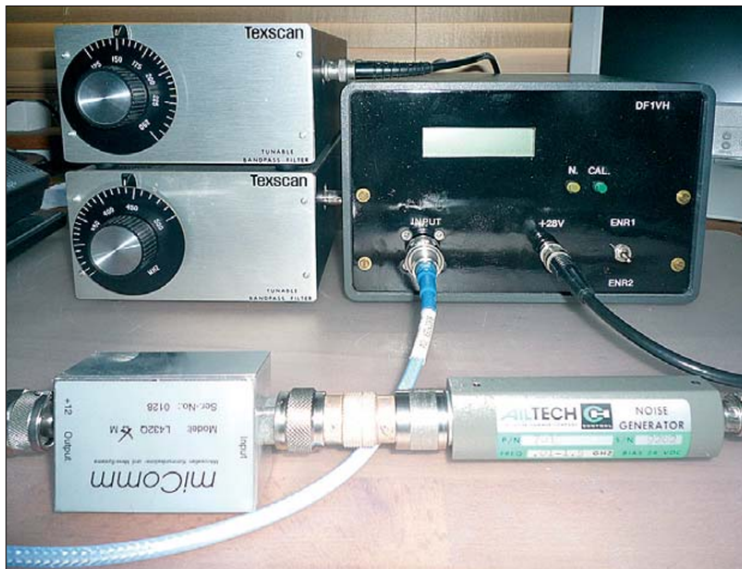
Bild 1: Messaufbau mit dem Mustergerät des SPANFI; im Vordergrund Messobjekt und Rauschquelle, hinten variable Bandpässe für 2 m und 70 cm daneben der SPANFI.
